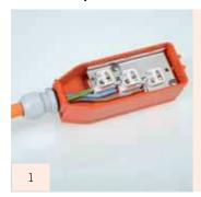
Retirer le couvercle du boîtier. Préparer le presse-étoupe, le monter sur le câble de dérivation (câble rond). Couper ce dernier à la longueur voulue et retirer la gaine. Introduire les brins dénudés.
