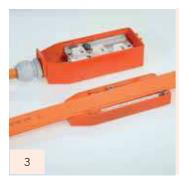
Placer soigneusement le câble plat. La cannelure au niveau de l'embase sert de repère - la faire coïncider avec la rainure du câble plat. Le positionnement se fera alors de lui-même, sans qu'il soit nécessaire de forcer. Le câble doit être propre, non abîmé et ne présenter aucune trace d'huile ou de graisse.
