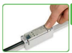
Faire glisser la partie supérieure sur la partie inférieure jusqu'à être en butée et la faire encliqueter. Presser le levier vers le bas et le verrouiller. Le contact des 3 conducteurs se réalise simultanément.
