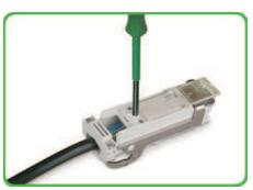
Couper, dégainer, dénuder et ensuite introduire la ligne de sortie. Serrer les vis. (Couple de serrage 0,7 Nm)
