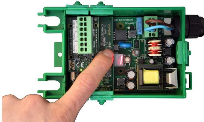
Une pression longue sur le bouton programmation du MASTER permet de passer en mode paramétrage. L'afficheur indique 'P' pour programmation puis 'o' pour OPEN.
