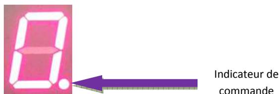
Lorsque l'indicateur (le point de l'afficheur) est éteint, le module transmet une commande de fermeture au clapet, lorsque l'indicateur est allumé, le module transmet une commande d'ouverture au clapet.
