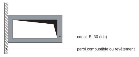
Il n'est pas exigé de distance de sécurité pour les canaux de ventilation des installations pour une température de l'air jusqu'à 40°C, situés à l'intérieur des appartements et des maisons individuelles.
