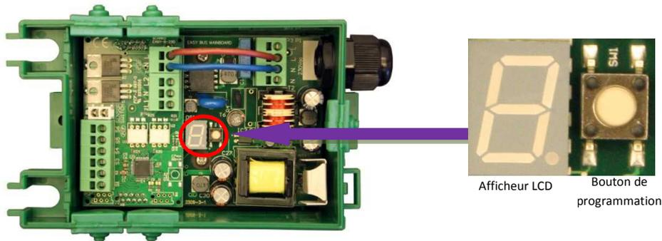
Easybus®-Module bedürfen einer eindeutigen Adresse zwischen 1 und 128, um in einem Easybus®-Netzwerk korrekt funktionieren zu können. Eine Ausnahme dazu bildet die Easy-P BACnet-Schnittstelle (siehe Seite 5).
