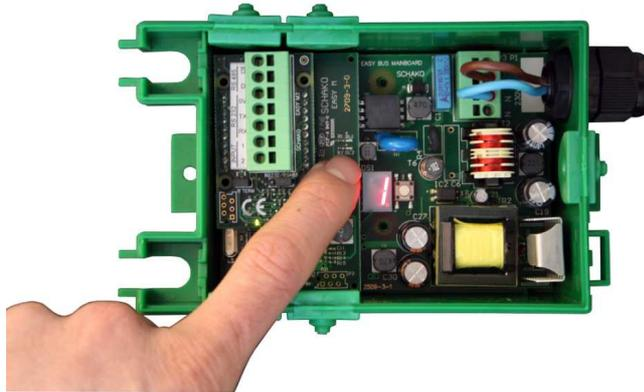
Durch längeres Drücken der Programmier Taste schaltet der MASTER in den Parametriermodus um. Die Anzeige wechselt von 'P' für Programmierung auf 'o' für OPEN.
