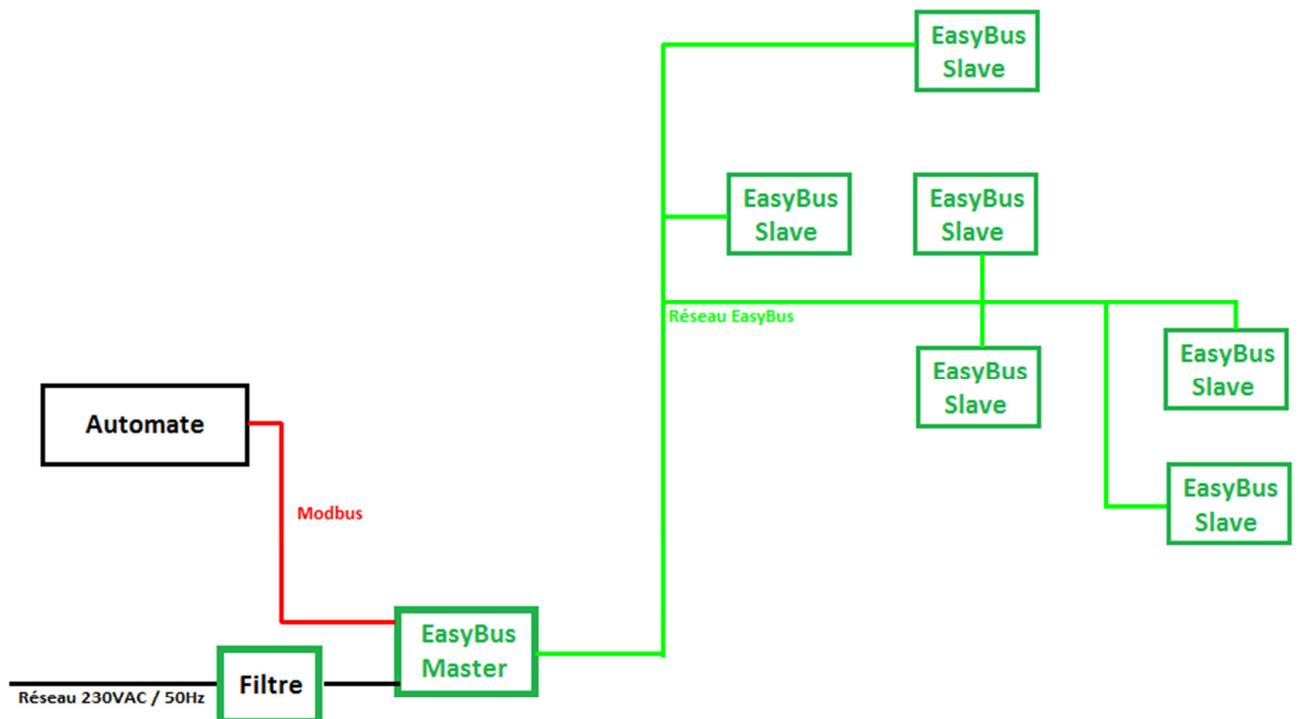
Das nachfolgende Schema illustriert eine Anlage mit 20 BSK-Modulen, 10 VAV-Modulen und einem Rauchmeldermodul. Jedes Modul besitzt eine eindeutige Bus-Adresse.
