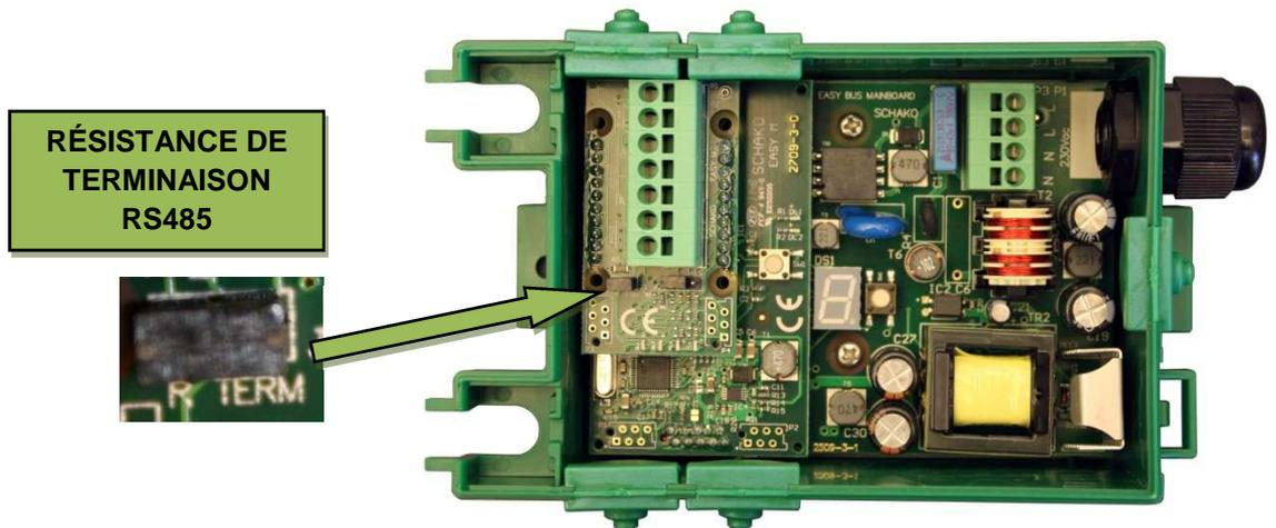
Abschlusswiderstände sind entsprechend der Norm RS485 am Anfang und Ende der Leitung anzuschliessen. Nicht korrekt aktivierte Widerstände führen zu instabilen oder nicht funktionierenden Modbus-Netzwerken.
