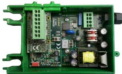
1 MODBUS-kompatibler Controller zum Dialogieren mit dem EasyBus®-Master(Easy-M).
