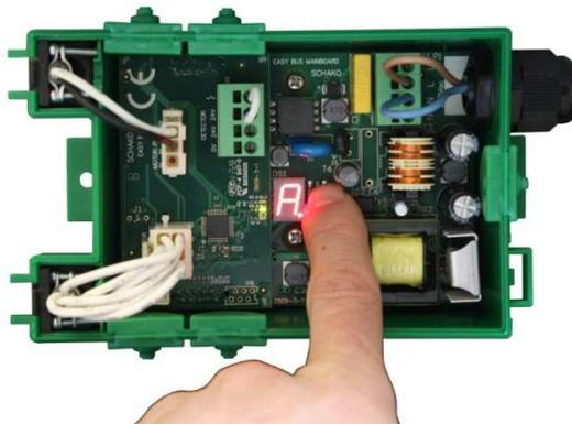
**Bemerkung:** Das Navigieren zwischen "A" (Adresse) und "C" (Kanal) erfolgt durch kurzes Drücken der Programmier Taste im Programmiermenu.
