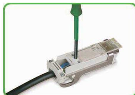
Abgangsleitung ablängen, abmanteln, abisolieren und einführen. Schrauben fest anziehen. (Anzugsdrehmoment 0,7 Nm)
