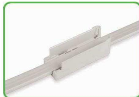
Unterteil positionieren und ggf. festschrauben. Flachleitung sorgfältig einschieben. Die Rippe im Verbinder-Unterteil muss mit der Nut im Leitungsmantel übereinstimmen.
