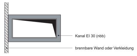
Bei Lüftungskanälen von Anlagen mit einer Lufttemperatur bis 40°C kann innerhalb von Wohnungen und in Einfamilienhäusern auf einen Sicherheitsabstand verzichtet werden.
