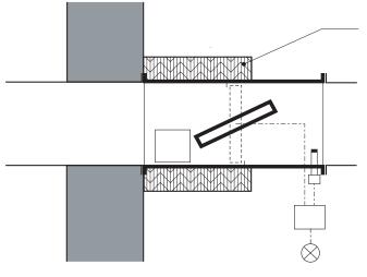
Verkleidung oder Gehäuse mit gleichem Feuerwiderstand wie brandabschnittbildender Bauteil
